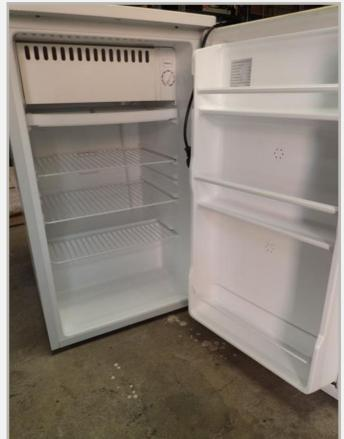
CONIA REFRIGERATOR CF140 CLIMATIC CATEGORY GROSS CAPACITY 109L NET CAPACITY 106L RATED VOLTAGE 240V~ RATED FREQUENCY 50Hz RATED INPUT POWER 90W ENERGY CONSUMPTION 0.8KW.h/24h REFRIGERANT R134a NET WEIGHT 28kg
